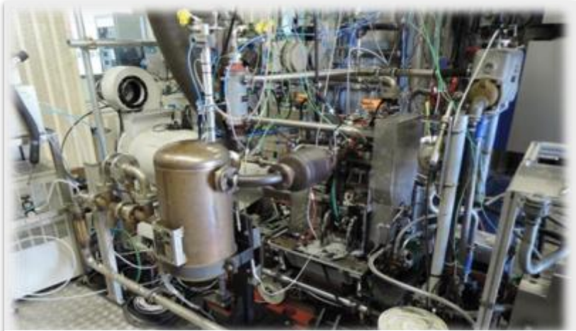
Tests sur banc mono-cylindre
