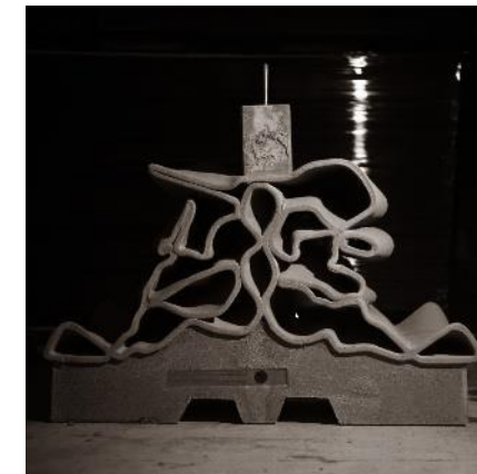
Recif'Lab : l'encre 3D béton au service de la biodiversité marine.
